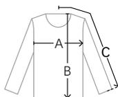
Alle Maßtabellen und Größenangaben unter Vorbehalt! Durch Schnittoptimierungen kann es zu geringfügigen Maßabweichungen kommen, weshalb wir eine Anprobe bei einem autorisierten HAKRO Fachhändler empfehlen. Maßtoleranzen bei A (=1/2-Oberweite), C (=Ärmlänge) +/- 1,5 cm und B (=Länge) +/- 2 cm.
